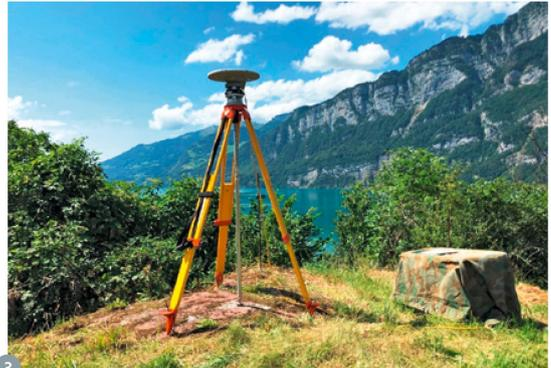
Abbildung 4: Zentrierung mittels Nadirlot. Die Zentrierung stellt sicher, dass sich der Messaufbau genau über dem Fixpunkt befindet.
