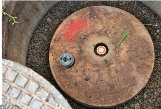
Abbildung 3: Statische GNSS-Messung auf dem LV95-Verdichtungspunkt Murg im Rahmen der GNSS-Kampagne 2022
