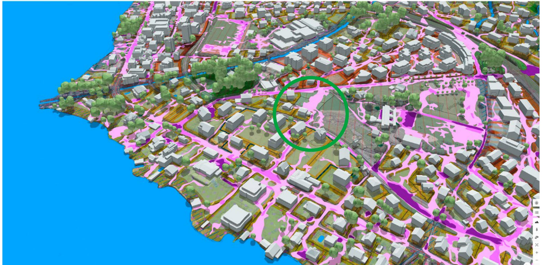
Figure 3: Commune d'Hergiswil: représentation en superposition de la carte de l'aléa ruissellement. De telles analyses et visualisations permettent de tirer des conclusions essentielles dans la phase stratégique de planification d'un projet.
