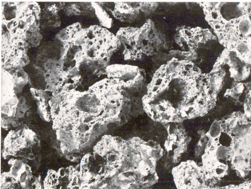
Abb. 1 Thermositkörnungen zweimal vergrößert
