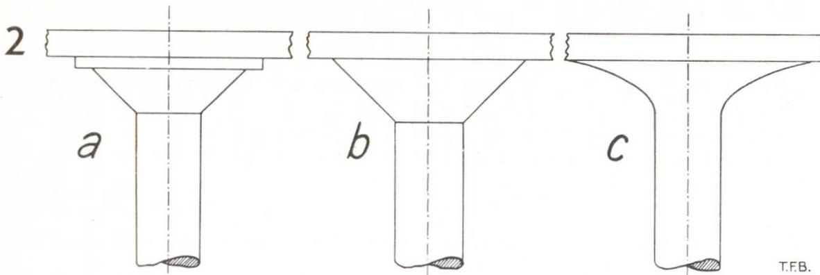
Abb. 1 Uebergänge von der Eisenbetonplatte zu den Säulenschäften
