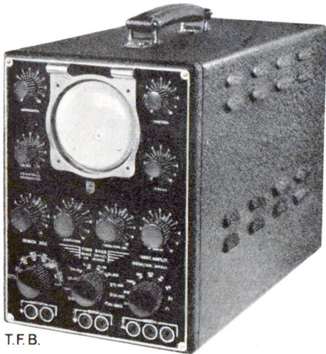
Abb. 6 Kathodenstrahl-Oszillograph (Philips) zum Messen und Sichtbarmachen von künstlich erzeugten Schwingungen. Auf elektrischem Weg ist, ähnlich wie bei Radioempfängern, eine fast beliebige Verstärkung des zu beobachtenden Phänomens möglich
