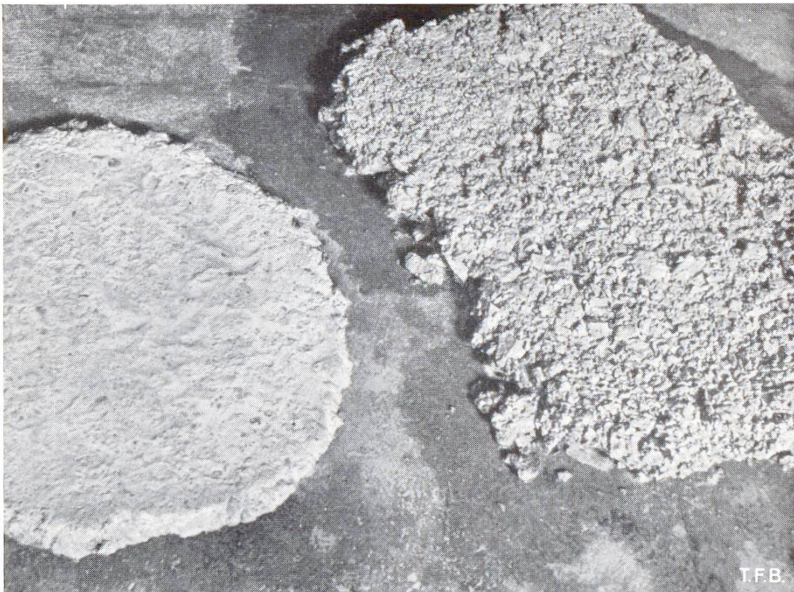
Abb. 2 Die unterschiedliche Streichfähigkeit einer geschmeidigen Mischung (links) und einer harschen Mischung (rechts) macht sich im Schliessen der Oberfläche und der Ausbreitränder bemerkbar
