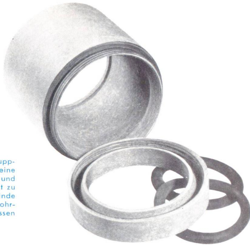
Abb. 5 Die „Simplex“-Kupplung mit Schraubring: eine Muffe, ein Schraubring und zwei Gummiringe. Es ist zu beachten, dass sich Gewinde in das Asbestcement-Rohrmaterial schneiden lassen
