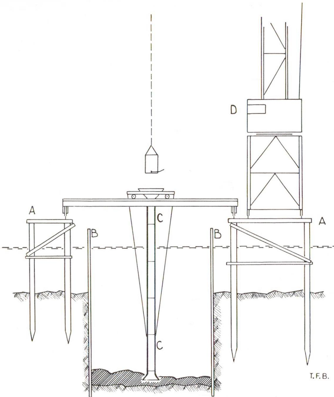
Abb. 4 Fahrbare Methode für Unterwasserbeton (schematische Darstellung).
