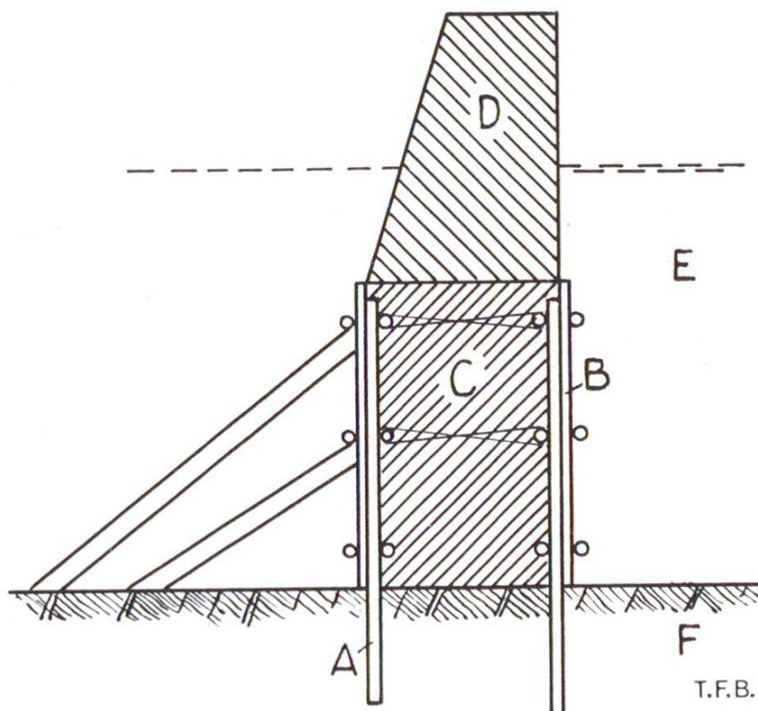
Abb. 2 Kraftwerk Rhyburg-Schwörstadt. Baugrubenabschluss durch Fangdamm aus Beton.
