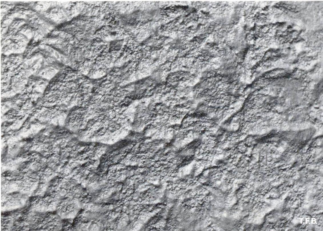
Abb. 6 Getönter Zierputz aus geschmeidigem hydraulischem Kalkmörtel
