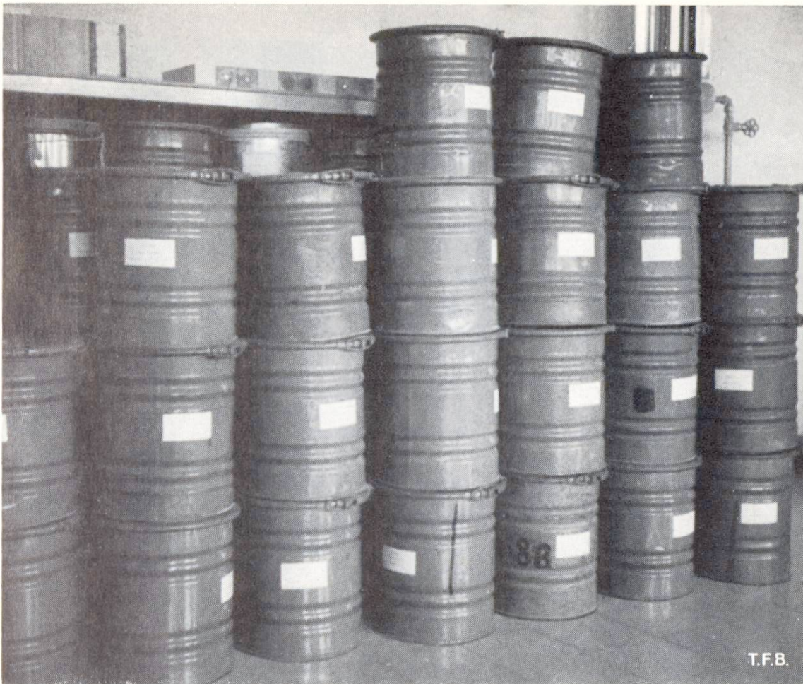
Abb. 4 Gefäße für Cementproben aus Silowagen. Inhalt: 10—15 kg
