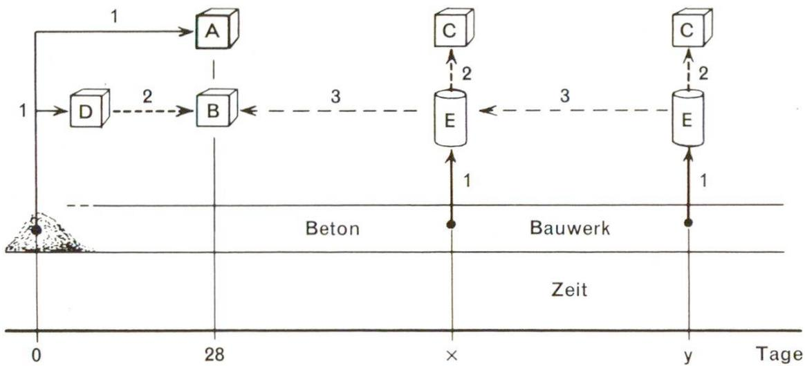
Abb. 1 Schematische Darstellung der Festigkeitsprüfungen an Beton.
