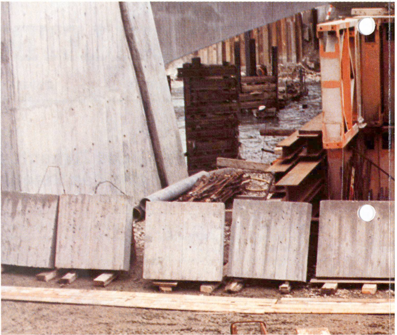
Abb. 1 Die 10 Beton-Versuchskörper auf der Baustelle, 6 Tage nach dem Ausschalen, Alter 10 Tage. Reihenfolge von links nach rechts: 5/3/10/6/8/9/1/7/4/2.
