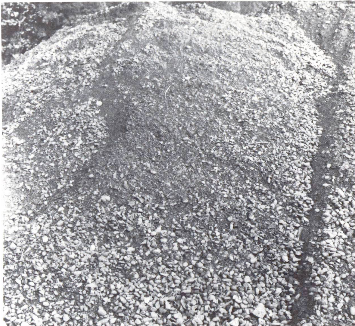
Abb. 3 Korngrößenentmischung am Depothonfen.
