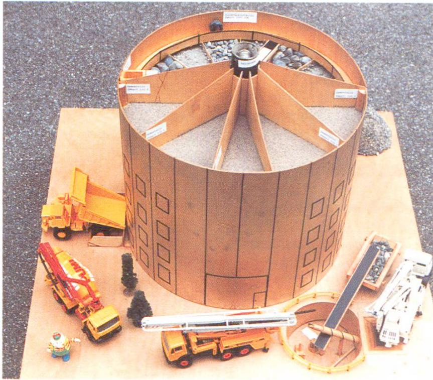
Abb. 3 Modellaufnahme. Links Gasse für Kieszufuhr, rechts Restbeton-Auswaschanlage.
