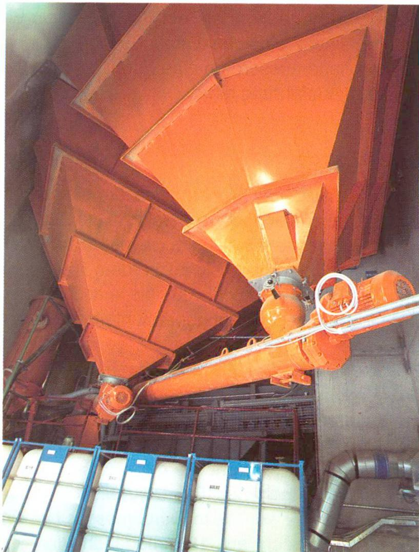
Abb. 8 Zementsilos aus Stahl; Zusatzmittel-tanks.
