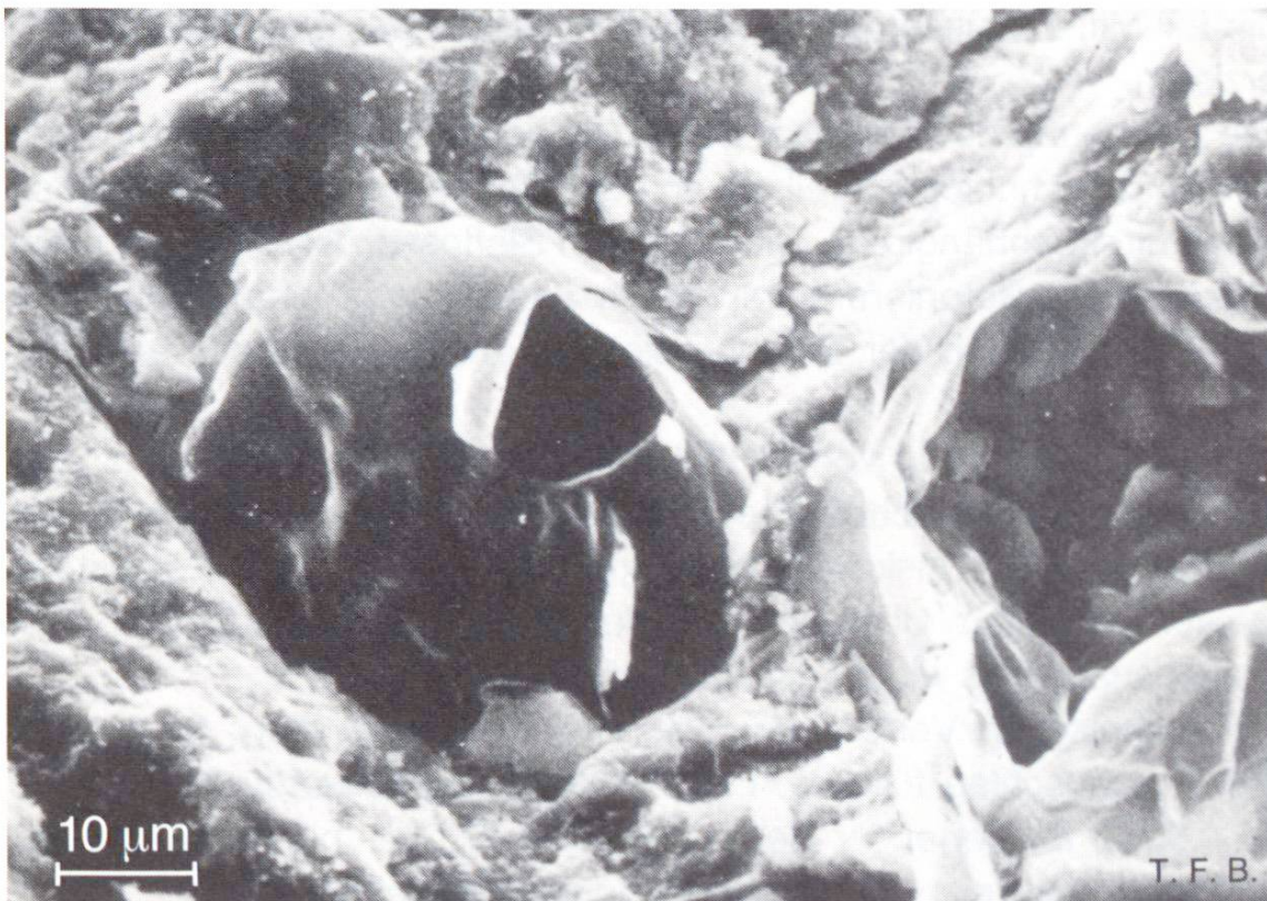
Abb. 4 Mikrohohlkugeln als Plastikkugeln sichtbar (bei der Präparation zerstört). Oben: Kapillarpore als «Riss» sichtbar.
