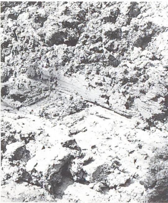
Abb. 2 Anstehendes Bodenmaterial (klebrig, durchnässt)
