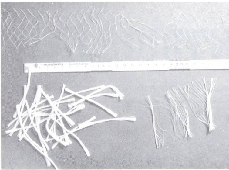
Fibrillierte Polypropylenfasern in Lieferform (unten links) sowie zwei unterschiedlichen Stadien der Vereinzelung.
