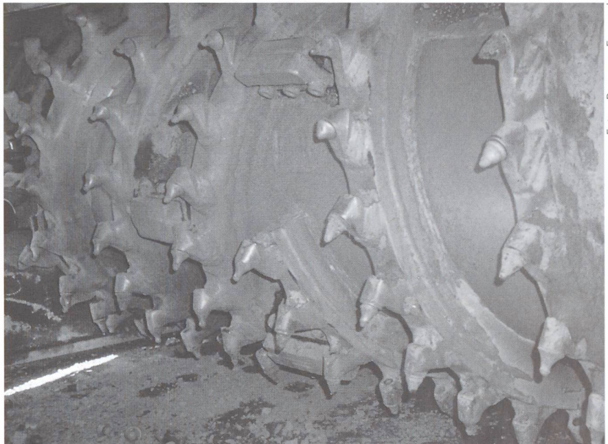
Fräswalze des Coldmixer Spezial (oben) und Rotor des Ra-Co 250 (unten).
