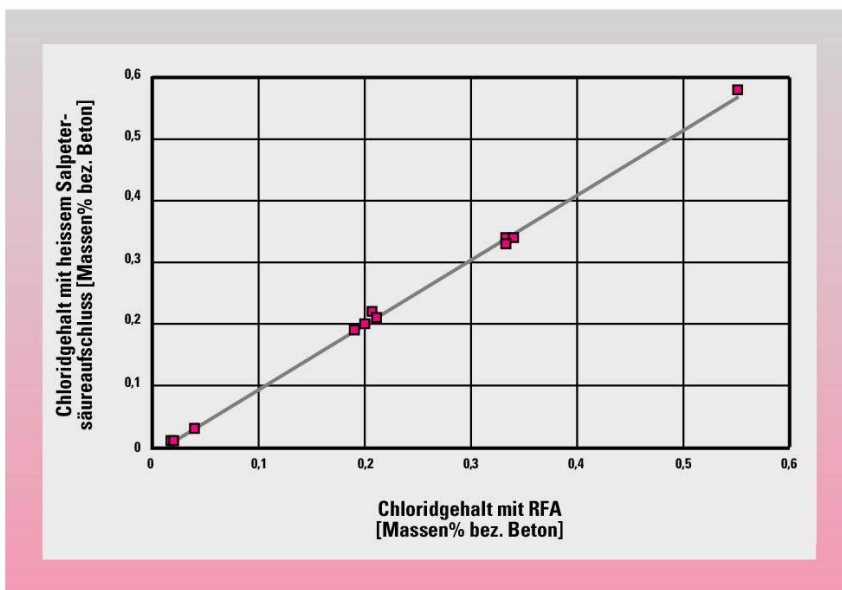
Abb. 1 Chloridbestimmung in verschiedenen Betonen und Mörteln: Korrelation zwischen den Resultaten aus der RFA-Bestimmung und den Resultaten aus der Bestimmung mittels Salpetersäureaufschluss gemäss Empfehlung SIA 162/2.
