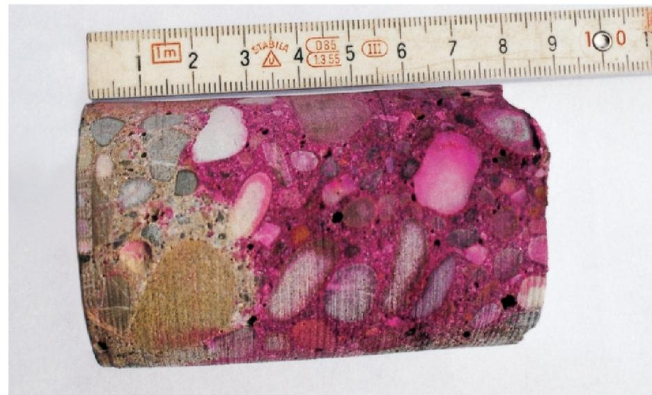
Nachweis der Karbonisierungstiefe mit Phenolphthalein an Bohrkern.
