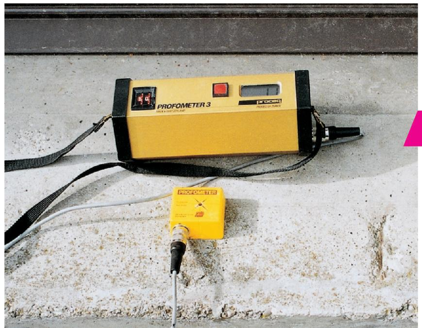
Messung der Überdeckung eines korrosionsgeschädigten Fenstersimses.
