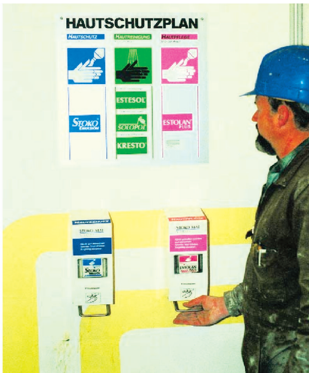
Abb. 11 Hautschutzplan mit Spender für Hautschutz und Hautpflege in einem Betrieb der schweizerischen Bindemittelindustrie.
