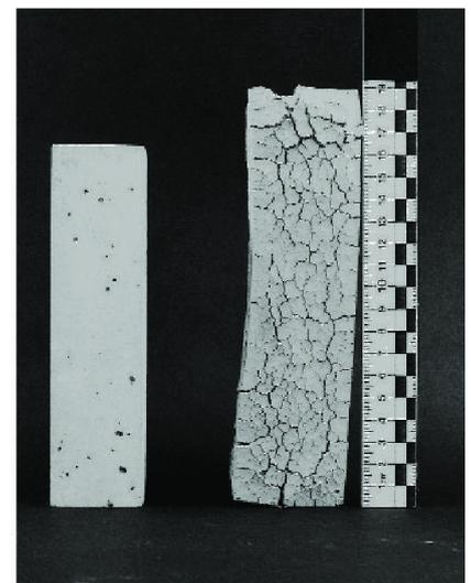
**Sulfatbeständigkeit von Mörtelprismen aus Portlandzement mit hohem Sulfatwiderstand (links) bzw. Portlandzement (rechts): Nach längerer Lagerung in einer Lösung mit einem hohen Sulfatgehalt treten nur beim Prisma aus Portlandzement Schäden auf.**
