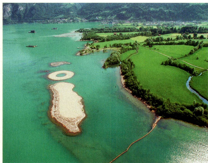
L'amoncellement créé par le creusement du Gothard, dans le delta de la Reuss, avant Flüelen.
