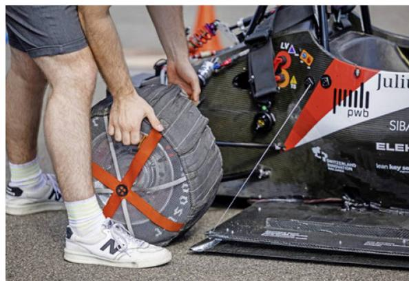
EN HAUT: Montage des pneus tempérés. On aperçoit le dispositif d'aspiration sous la voiture.
