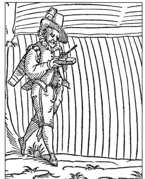
Abb. 3: Feldmesser bei der Arbeit im Gelände. Er verwendet dabei einen Kompass mit einer Zielvorrichtung zur Richtungsbestimmung. Die Distanz ermittelt er durch das Schrittmass. Holzschnitt aus Paul Pfinzing: Methodus Geometrica , Nürnberg 1598.
