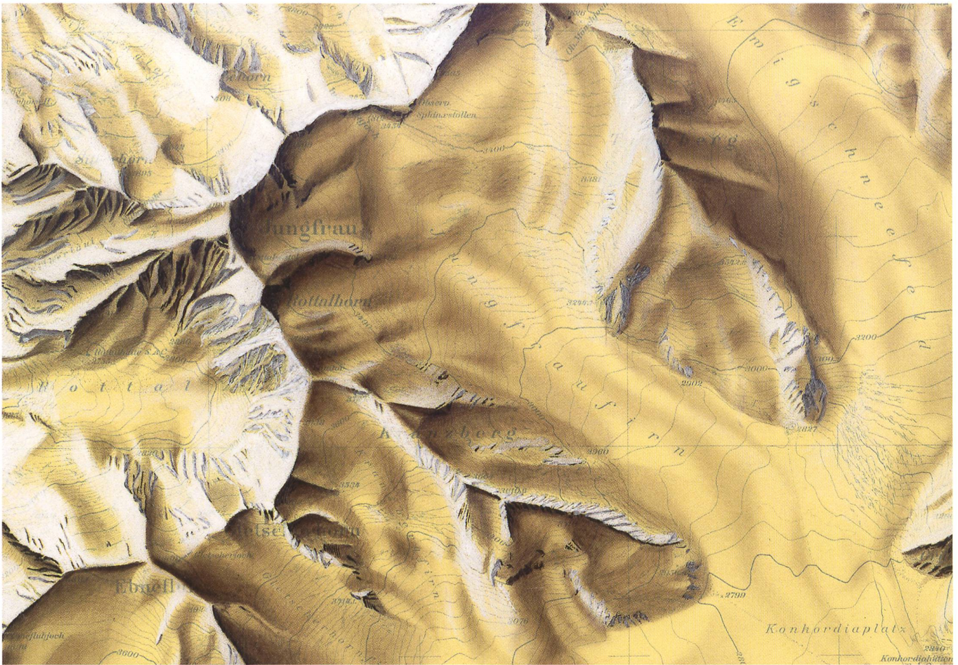
Abb. 61: Einfarbiges Relieforiginal auf gelbem Zeichenpapier für Blatt 264 Jungfrau 1:50 000, ca. 1955. Die Schattenseiten wurden mit Bleistift, Kreide und Aerograph bearbeitet, die Lichtseiten mit Deckweiss hervorgehoben (© L+T).
