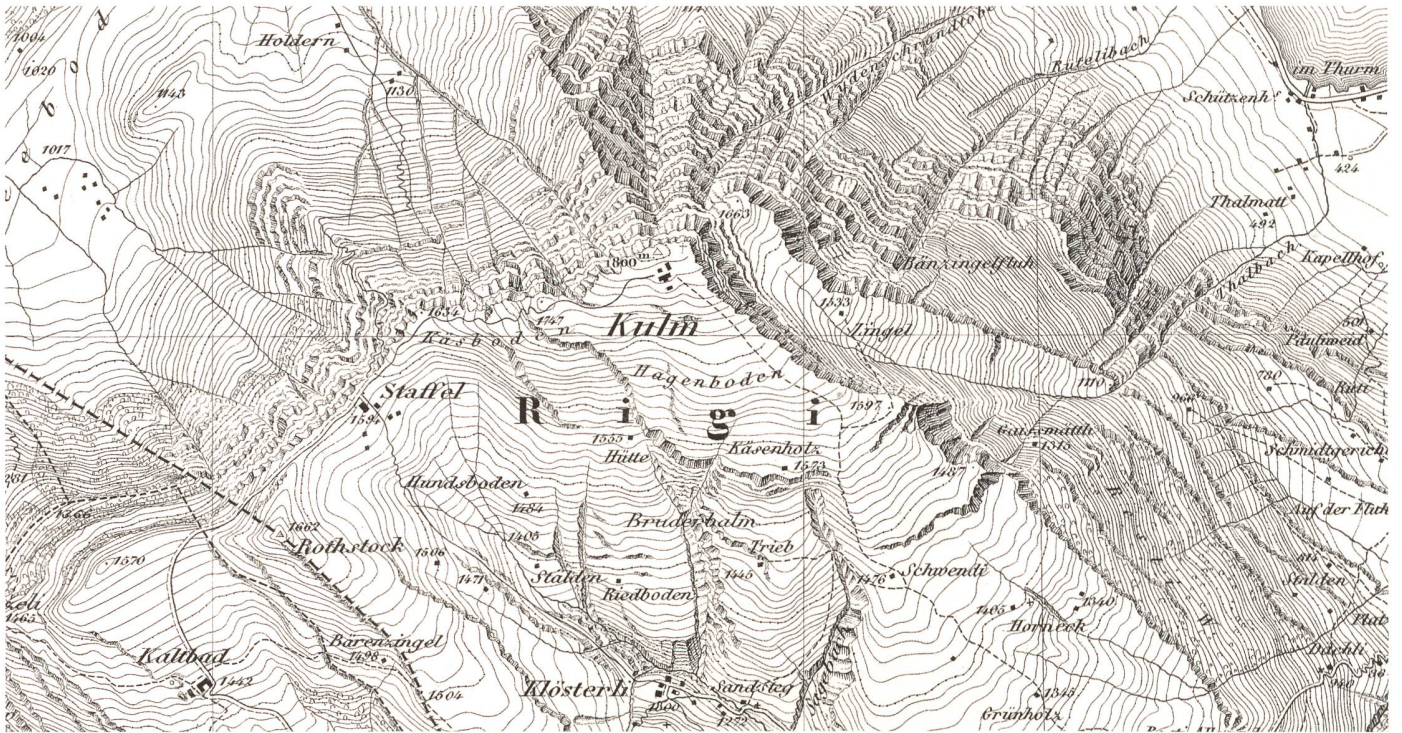
Abb. 12: Topographische Karte des Kantons Luzern 1 : 25 000 von Ernst Rudolf Mohr, Kupferstich von Heinrich Müllhaupt. Erste Ausgabe 1864 mit Höhenkurven. Ausschnitt aus Blatt 8.
