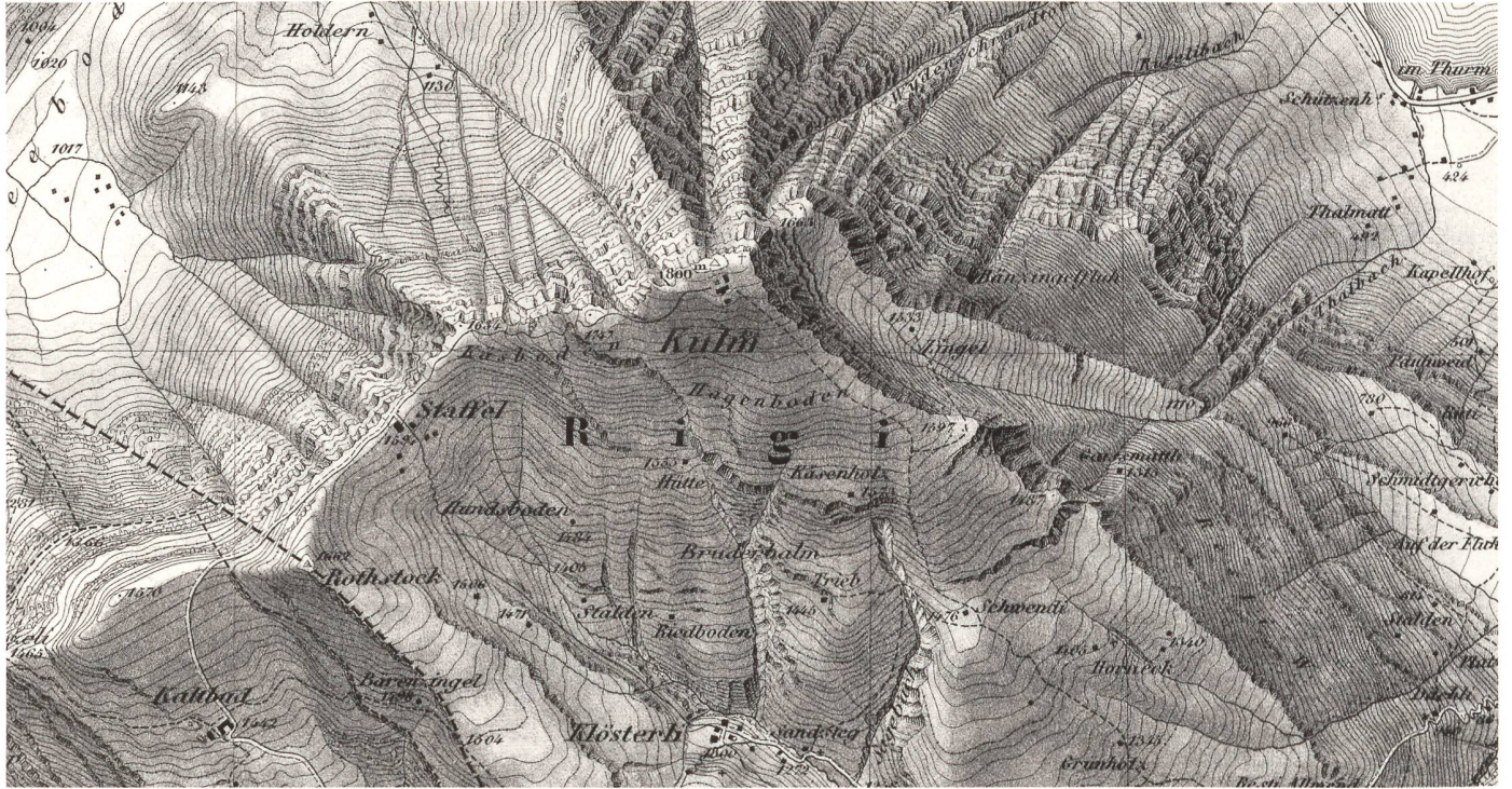
Abb. 13: Gleicher Ausschnitt wie Abb. 16 mit zusätzlichem Reliefton, der mit der Roulette erzeugt wurde.
