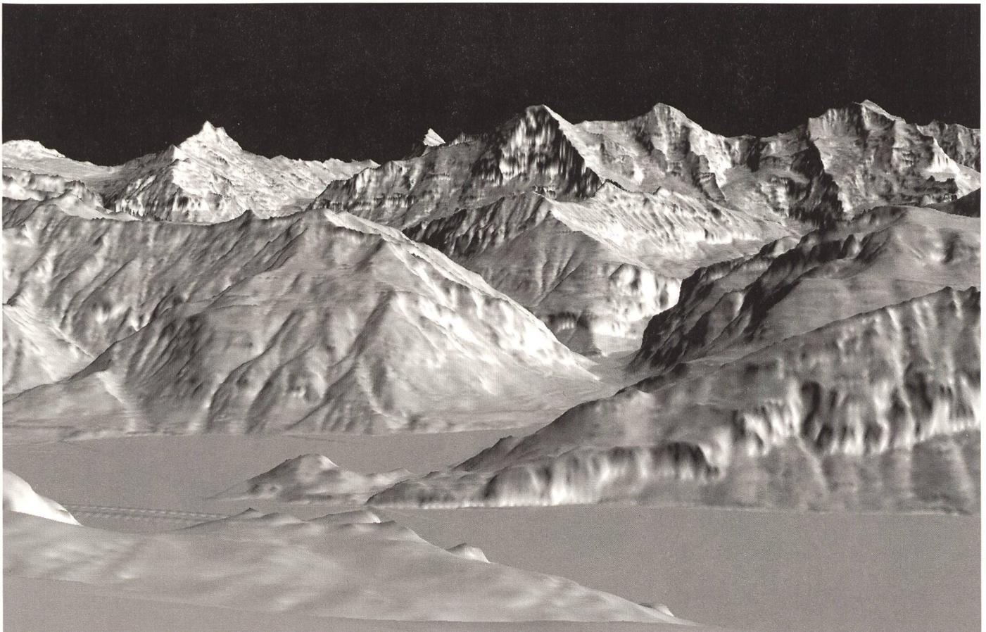
Abb. 77: Für diese Darstellung wurde zunächst ein Schattierungsbild berechnet, dem eine Beleuchtung von Südwesten zu Grunde liegt. Die Bodenauf Auflösung eines Grauwert-Elementes (Pixel) beträgt 5 m. Anschliessend wurde dieses Schattierungsbild nach den gleichen geometrischen Bedingungen wie Abb. 75 perspektivisch umgebildet (© L+T).
