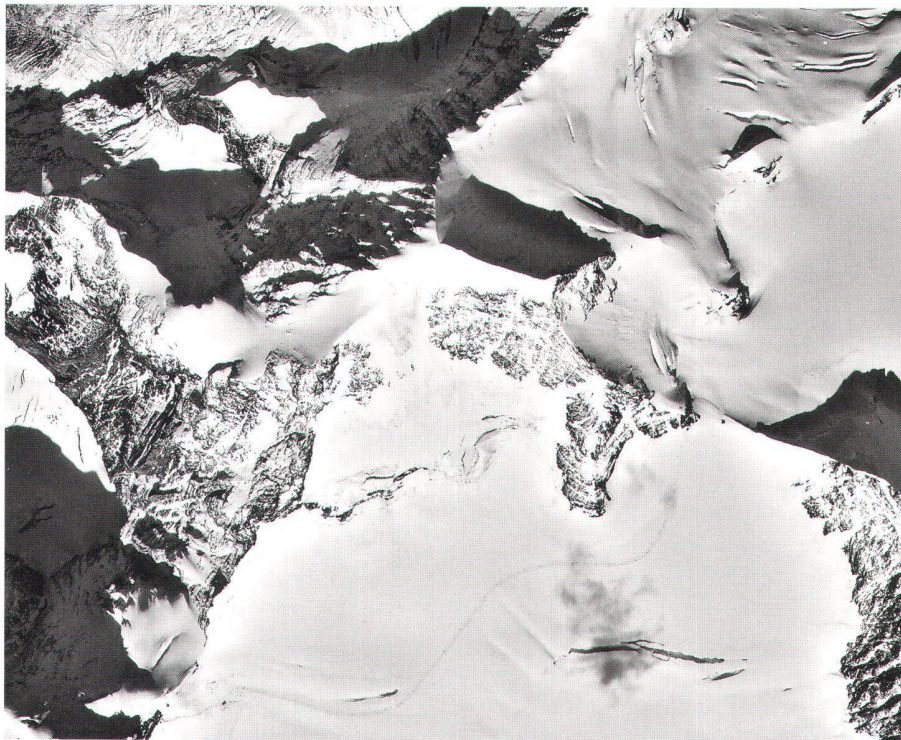
Abb. 13: Dieses Luftbild wurde bei der Höhenbestimmung in der Gesamtnachführung 1993 mitverwendet: Aufnahme aus 6400 m ü.M. (Photothek L+T, Aufnahme 4983 aus der Fluglinie 565 der Landeskarte 1 : 50 000 Blatt 264 Jungfrau vom 20.9.1993, 13.55 Uhr aus 6400 m ü.M. mit einer RC-30-Kamera von Leica).
