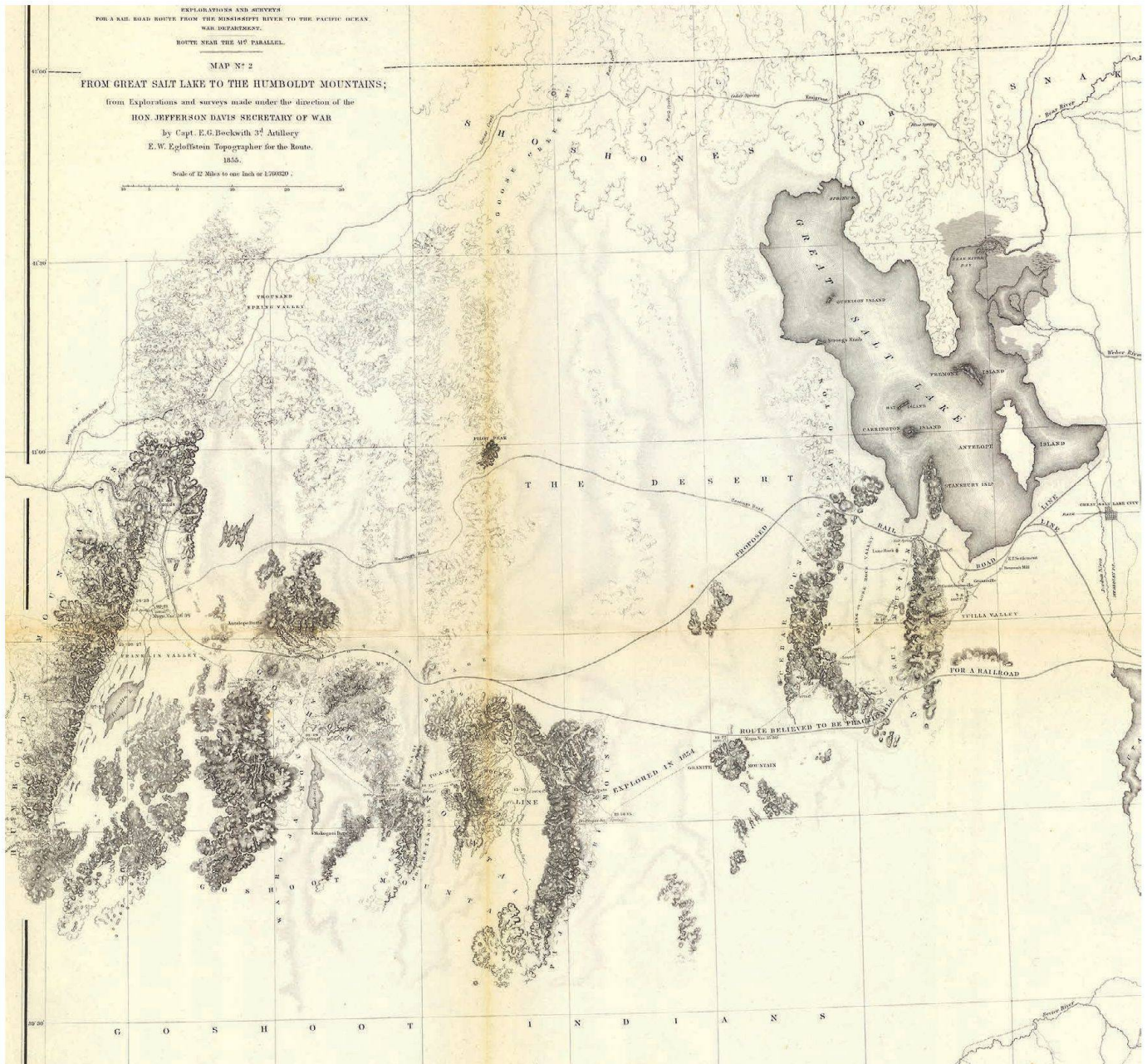
Abb. 4: Ausschnitt des Kartenblatts Map 2: From Great Salt Lake to the Humboldt Mountains der Beckwith-Expedition im Massstab 1:760 320 (1 Inch = 12 Miles) mit den begangenen Routen in gestrichelter Linie und der vorgeschlagenen Eisenbahntrasse in Doppellinie (Quelle: Beckwith 1855b: Map No. 2; www.davidrumsey.com Image No. 0693.029).
