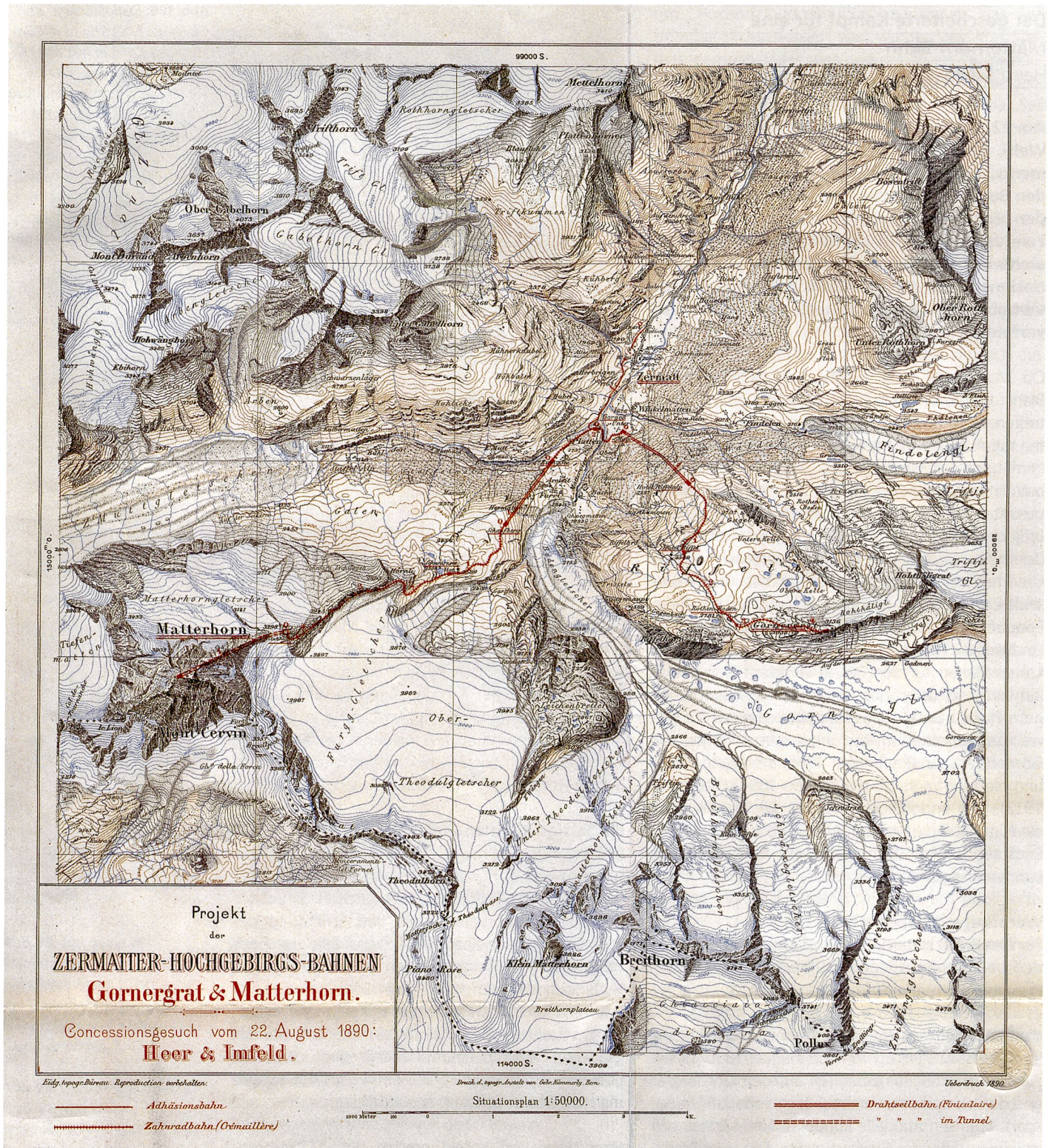
Abb. 101: Projekt der Zermatter-Hochgebirgs-Bahnen Gornergrat & Matterhorn. Concessionsgesuch vom 22. August 1890: Heer & Imfeld. Überdruck des Topographischen Atlas der Schweiz (Siegfriedkarte) 1:50000, Format: 28x30 cm (BAR, Bestand: E 53-585-02).
