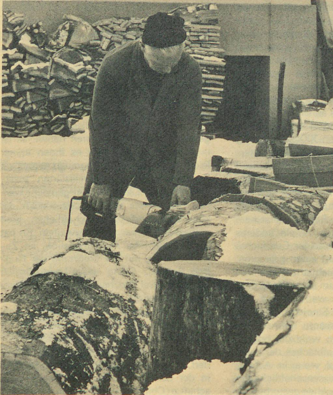
Lenz Krättli sägt die harzhaltigen Lärchenstämme, die sich zur Herstellung von Schindeln besonders gut eignen.
