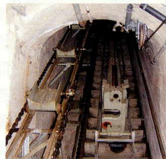
Munitionsaufzug zu einem der Geschütztürme.
