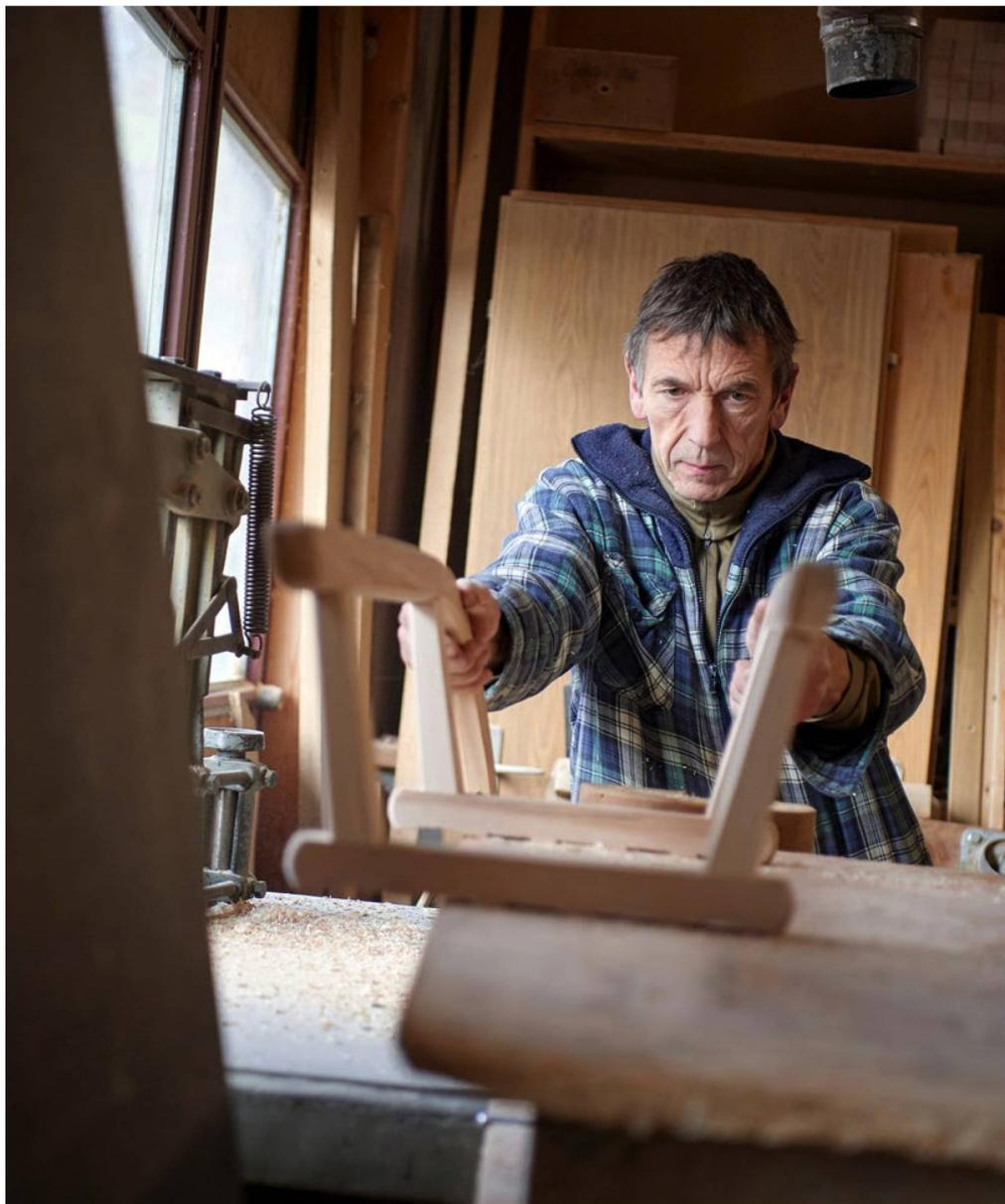
Schlitten ausmacht: Er muss zwingend aus Eschenholz gefertigt sein. Dieses Holz ist hart, zäh, langfaserig und elastisch zugleich. Somit lassen sich die Kufen des Schlittens gut biegen. Und die Sitzlatten federn, ohne zu brechen.
