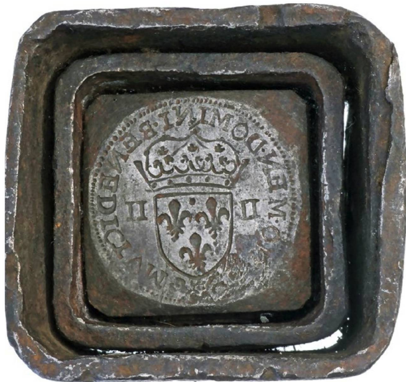
Obereisen für die Klippwerk- oder Stosswerkprägung eines Viertel-Talers. Königreich Frankreich, Heinrich IV (1589-1610), unbekannte Werkstatt.
