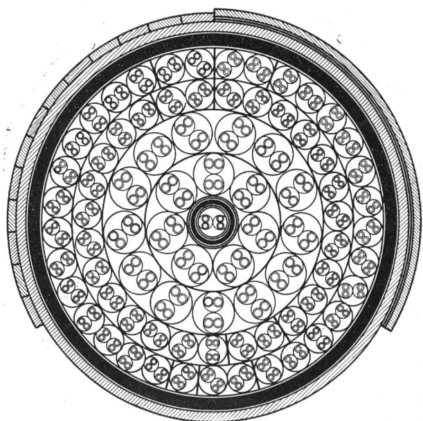
Fig. 28. Querschnitt des Kabels mit 81 Vierern.
