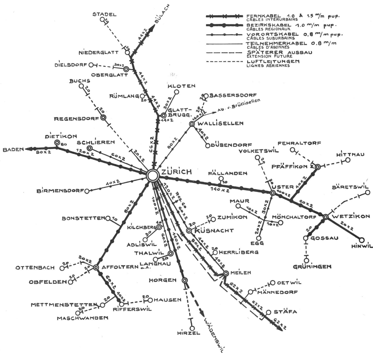
Fig. 10. Kabelnetzplan. — Plan du réseau des câbles.
