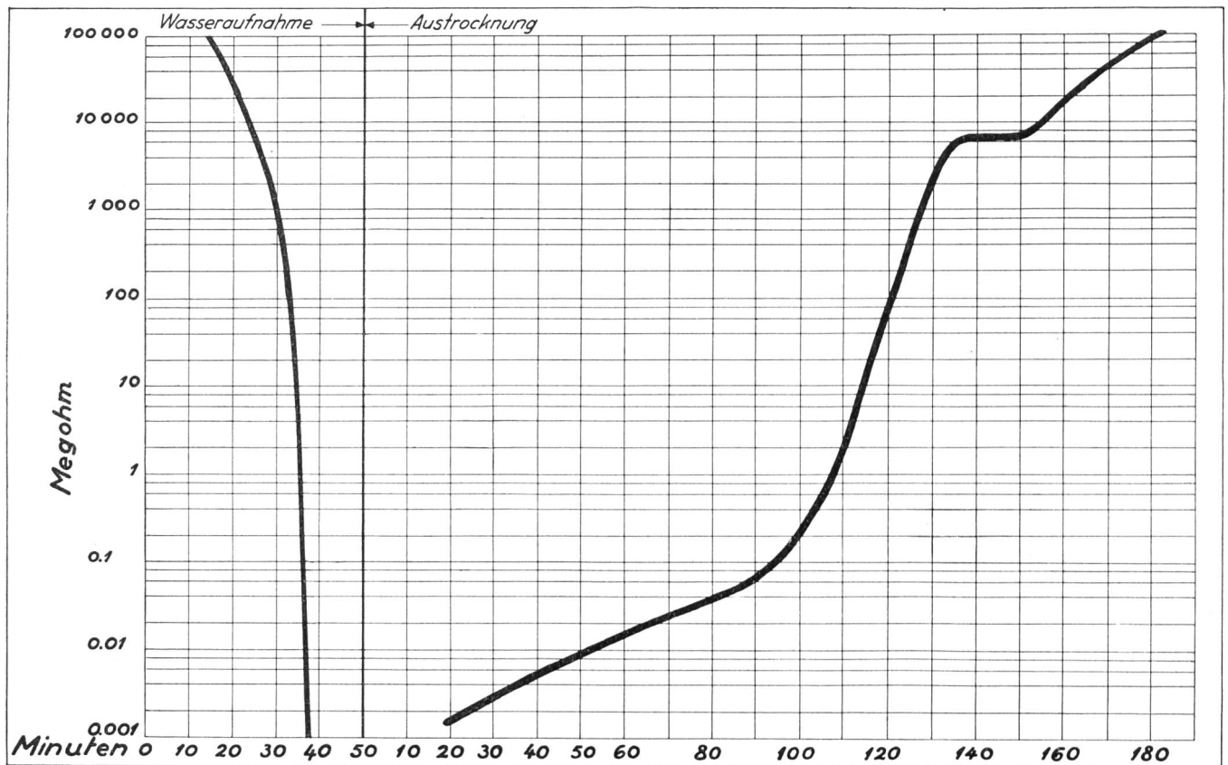
Fig. 8. Isolationszustände einer durch Wasser verdorbenen Spleissung. — Etat d'isolation d'une épissure détériorée par l'eau. Légende: Wasseraufnahme. — Absorption d'eau. — Austrocknung. — Séchage.
