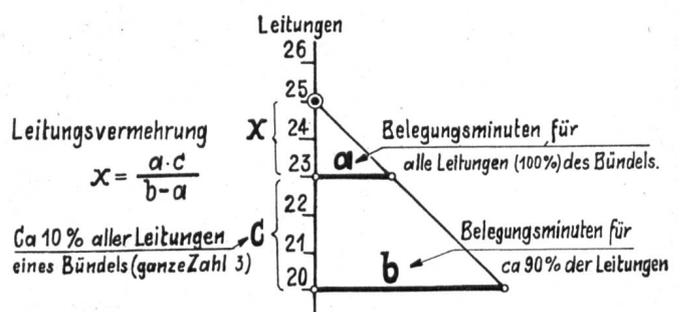
Fig. 2. Berechnung der Leitungsvermehrung.
