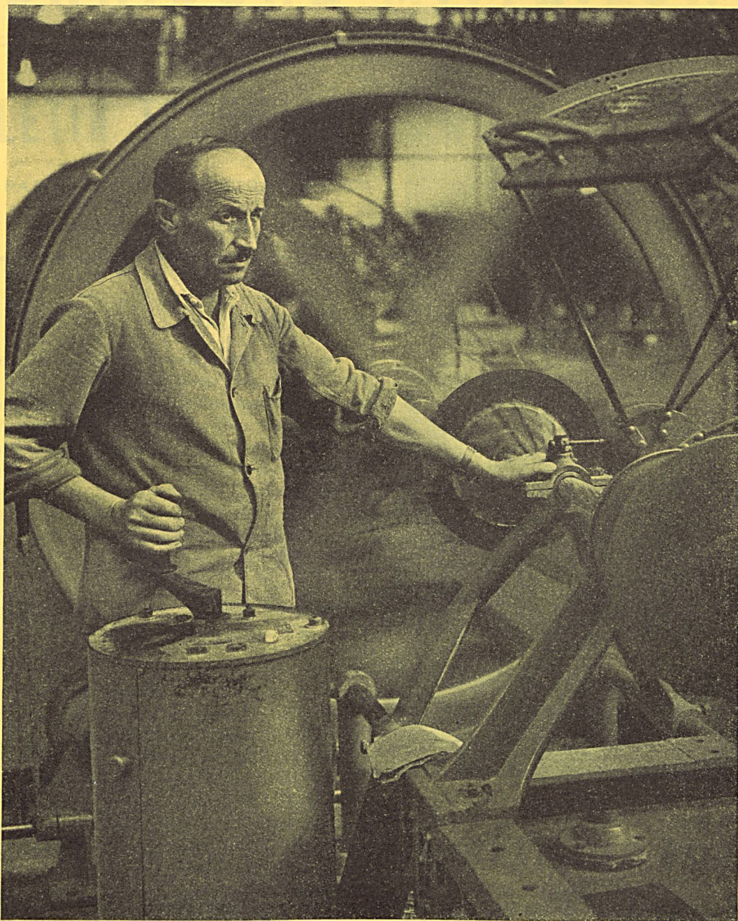
Verseilen eines Telephonkabels
