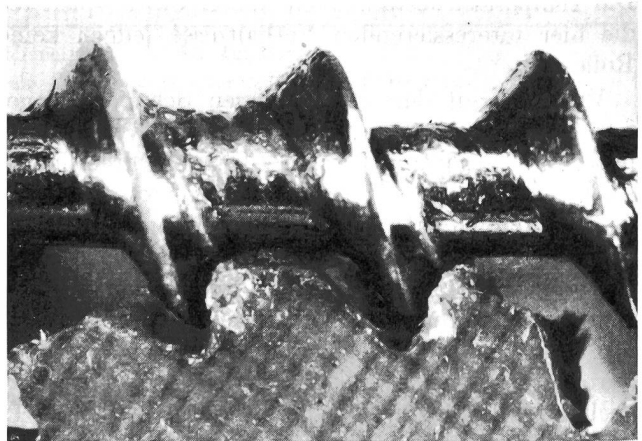
Fig. 17. Nummernschalter Nr. 10. Schnecke und Schneckenrad in gefettetem Zustand. Die Zahnkanten des Schneckenrades sind teilweise defekt. Der Nummernschalter blieb nach 434 345 Abläufen stecken
