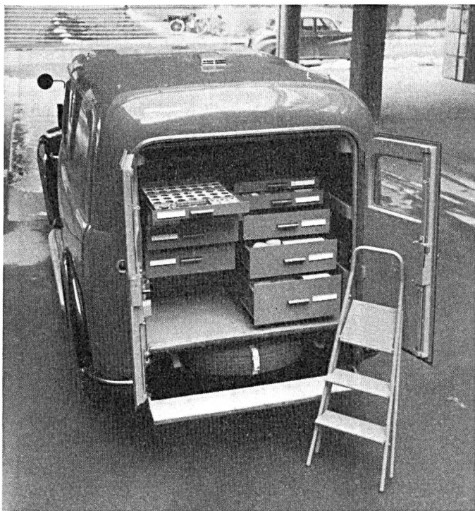
Fig. 4. Ausrüstung eines Fahrzeuges für den Unterhaltsdienst Équipement d'une voiture pour le service d'entretien
