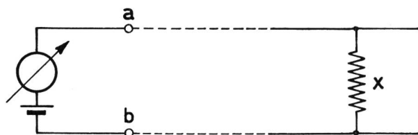
Fig. 1. Messung einer offenen Einzelleitung mit dem Isolationswiderstand x Mesure d'un circuit ouvert avec la résistance d'isolement x
