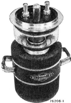
Fig. 2. Kurzwellensendetriode mit thoriierter Kathode für eine Verlustleistung von 6 kW
