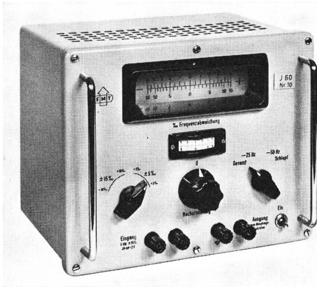
Fig. 1. Discriminateur «EMT» servant à mesurer les écarts instantanés d'un signal enregistré de 5000 Hz.
