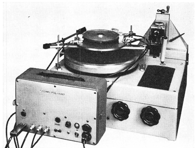
Fig. 2. Appareil de mesure des variations de la vitesse angulaire d'un tourne-disques, placé sur une machine d'enregistrement MAG.
