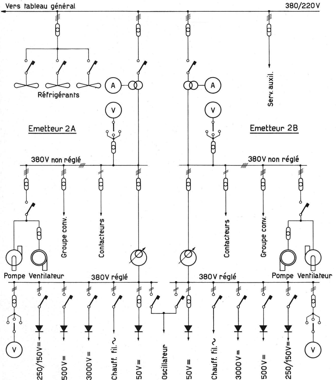
Fig. 5. Schéma de l'alimentation 380 V de l'émetteur
