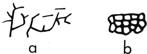
Fig. 11. Structure de la surface des contacts en argent-palladium, soumis à l'étincelle à haute tension
