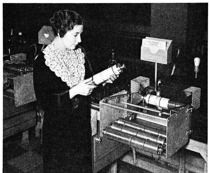
Fig. 5. Faksimileapparate für Hauptämter und grössere Filialen mit automatischer Ladung der Walzen
