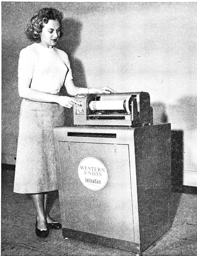
Fig. 8. Intrafax-Apparat für die automatische, originalgetreue Übermittlung von Briefen, Katalogblättern usw. mit einer Geschwindigkeit von 300 Worten in der Minute, was mehr als der doppelten Leistung einer erstklassigen Maschinenschreiberin entspricht. Eine Angestellte übermittelt durch einfachen Druck auf einen Knopf eine umfangreiche Preisliste vom Hauptgeschäft an die Filialen
