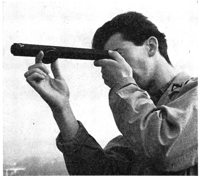
Fig. 7a. Mesure de la distance des conducteurs Messung der Leiterentfernung
