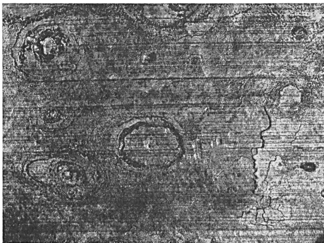
Fig. 5. Detail aus der Oberfläche der geteerten Bleiprobe der Figuren 1...4. Neben eingätzten Furchen und Grübchen sind auch vereinzelte interkristalline Spalten aufgetreten. Vergrößerung: 4×
