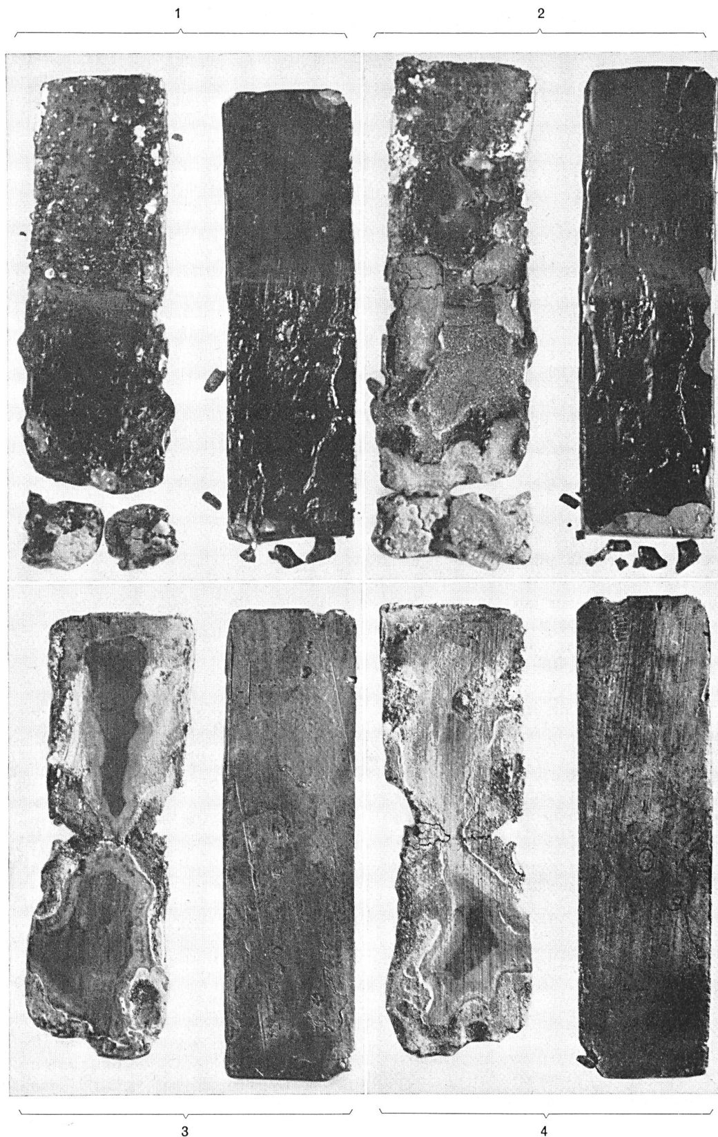
Fig. 1...4. Zwei Bleiprobe, die ein Jahr mit der unteren Hälfte in Hellerscher Lösung gestanden haben. Die linke stark korrodierte Probe war mit Bitumen, die rechte mit Teerprodukten bestrichen. Die Figuren 1 und 2 zeigen die Vorder- und Rückseite der ungereinigten, die Figuren 3 und 4 die der mit Benzol gereinigten Proben. Natürliche Grösse
