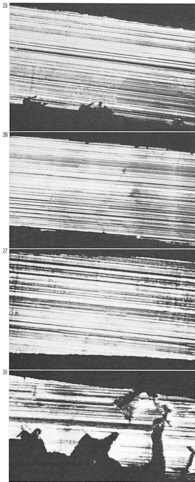
Fig. 25...28. Querschnitt durch Bleiprobe, die 5 Monate in 100 cm 3 Hellerscher Lösung lagen, die mit 1 g Substanz einer hochsiedenden Teerfraktion mit den Siedegrenzen 360...420° C (Fig. 25) oder 1 g Neutralkörper (Fig. 26) oder 1 g basischer Körper (Fig. 27) oder schliesslich 1 g saurer Körper (Fig. 28) der gleichen Fraktion versetzt war. Die unterschiedliche Schutzwirkung der verschiedenen Stoffgruppen ist auffällig. Vergrösserung: 23 ×
