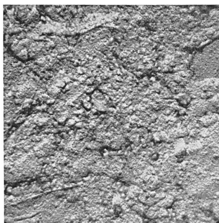
Fig. 17. (links) Oberfläche der schichtbedeckten Innenseite eines Kabelmantels. Im Vergleich mit den Modellversuchen gibt die Morphologie keinen Anhaltspunkt über die Zusammensetzung der Deckschicht. (Abdruckbild) Vergrößerung: 8000×
